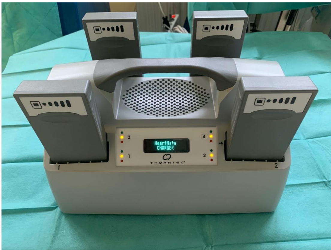
Fot.14 Ładowarka do baterii systemów HeartMate II i HeartMate 3. Fot. Jarosław Szymański, archiwum własne.
