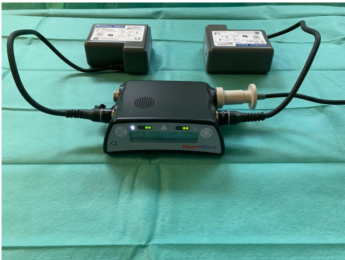
Fot.16 Sterownik systemu HVAD z podłączonym kablem zasilającym i dwoma źródłami zasilania. Fot. Jarosław Szymański, archiwum własne.
