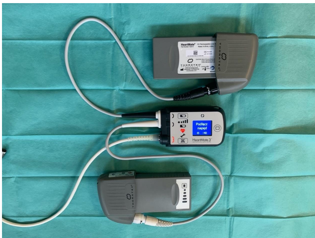
Fot.12 Sterownik HeartMate III podłączony do baterii. Fot. Jarosław Szymański, archiwum własne.
